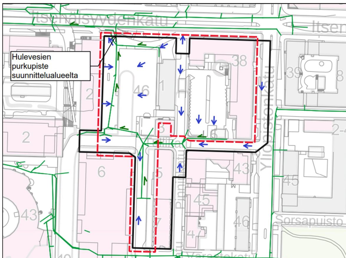
Kuva 4. Virtausreitit ja -suunnat suunnittelualueella. Siniset nuolet kuvaavat pintavalunnan virtaus-suuntaa ja vihreät nuolet virtaussuuntaa hulevesiverkostossa. Hulevesiverkosto on esitetty vihreällä. Valuma-alue suunnittelualueen hulevesien purkupisteelle on merkitty mustalla ja suunnittelu-alue punaisella katkoviivalla.
